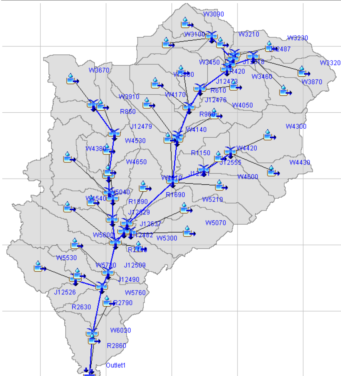
Figura 4.1 – Bacia da rib a de Algés. Topologia da rede – aplicação do modelo HMS
