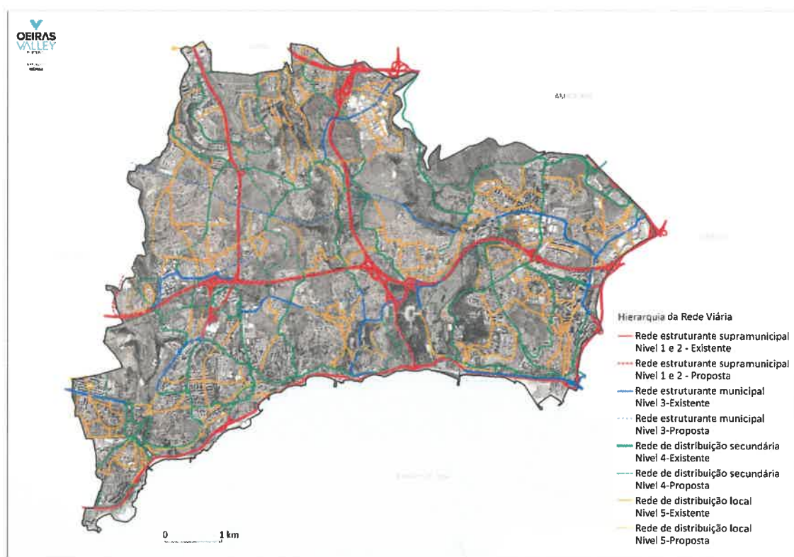
Figura 18: Rede viária no Município de Oeiras (Oeiras M. d., Plano de Mobilidade Urbana Sustentável do Município de Oeiras ).
