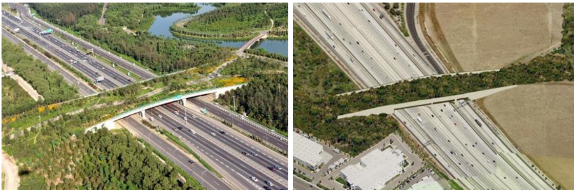
Figura 19 - Exemplos de corredores ecológicos em autoestradas, ligando espaços verdes fragmentados
