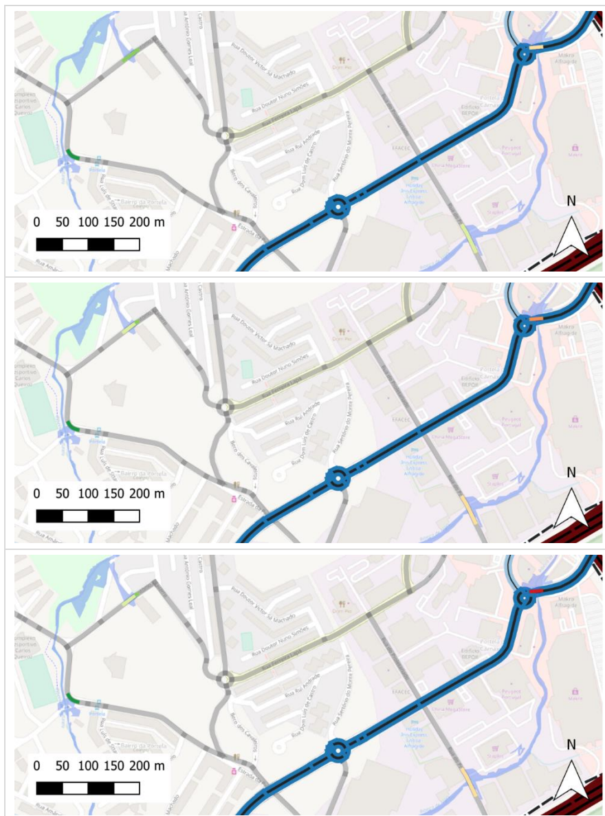
Figura 21 – Bacia de Algés, zona de Portela de Carnaxide, vulnerabilidade das infraestruturas de transportes a cheias e inundações pluviais. No presente (cima), e em cenários futuros: 2011-2040 (RCP4.5) e 2041-2070 (RCP8.5) (meio) e 2071-2100 (RCP8.5) (baixo)
