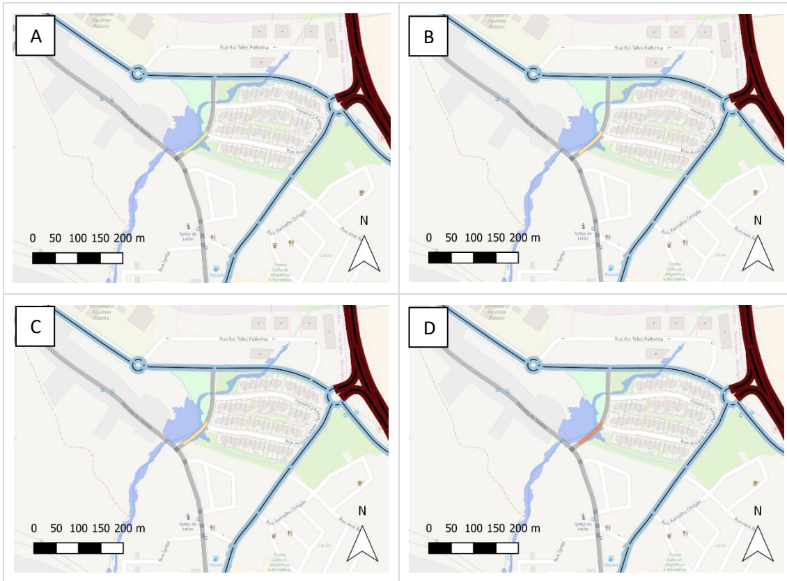
Figura 10 - Bacia da Laje, ribeira de Leião, Localidade de Leião, vulnerabilidade das infraestruturas de transportes a cheias e inundações pluviais. (A) presente, e em cenários futuros (B) 2011-2040, RCP4.5; (C) 2041-2070 e (D) 2071-2100, RCP8.5
