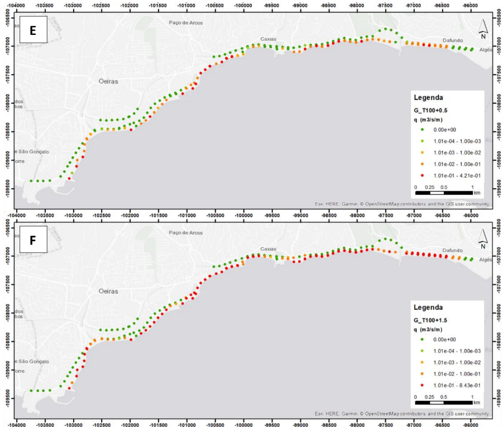
Figura 20 - Caudal médio de galgamento no passeio marítimo (A), Av. Marginal (B) e Linha Ferroviária(C), e distribuição espacial dos níveis de caudal de galgamento para os cenários de Ref. (D), +0,5 m (E) e +1,5 m (F), para T=100 anos
