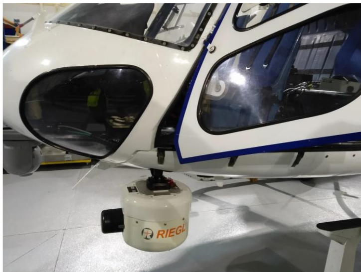
Figura 50 - Equipamento LiDAR utilizado na recolha de dados
