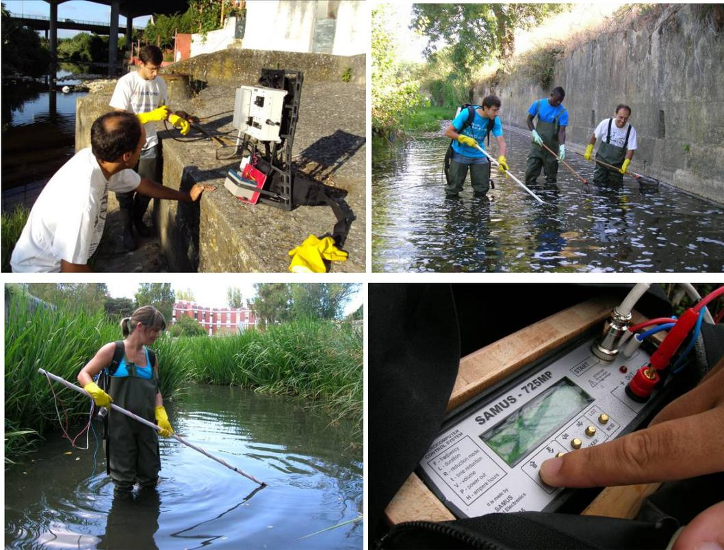
Figura 5 – Equipamento de pesca elétrica (aparelho de transporte dorsal com bateria).
